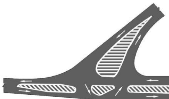
Hình G.31 - Bố trí vạch kênh hóa dòng xe ở ngã ba phức tạp - Mẫu 2
