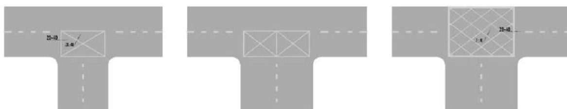
Hình G.39 - Minh họa bố trí vạch kẻ kiểu mắt võng tại nút giao ngã ba
