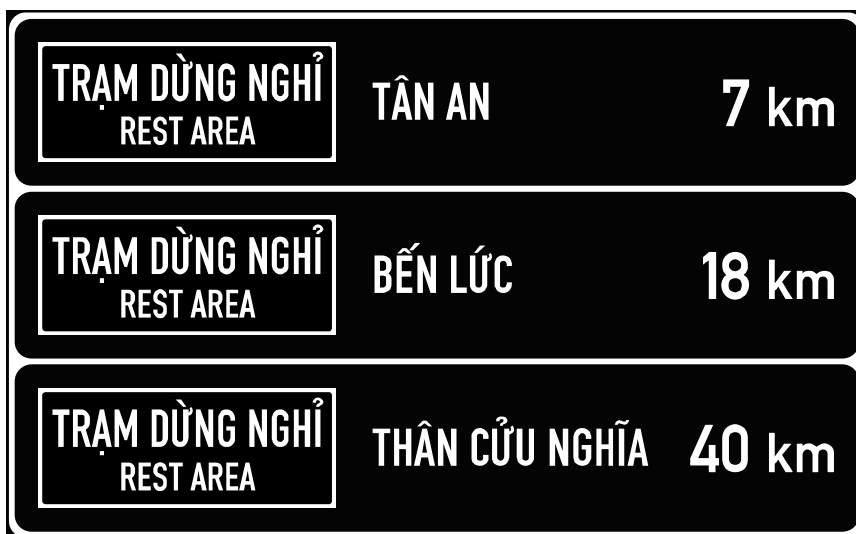
Hình 17. Biển số IE.458 chỉ dẫn khoảng cách đến trạm dừng nghỉ tiếp theo
